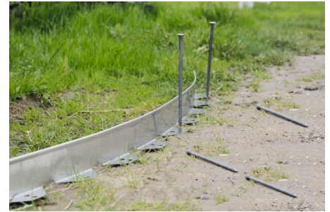
3 pav. Borto montavimo pavyzdys
